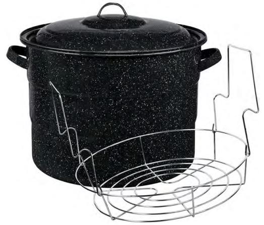
La envasadora debe ser lo suficientemente profunda como para que al el agua hirviendo esté al menos 2,5 cm sobre los frascos tapados durante el procesamiento. Algunas envasadoras de agua hirviendo no tienen fondos completamente planos y no funcionan bien sobre las estufas de superficie lisa. De igual manera, el fondo de la envasadora debe ser bastante plano para poder usarlas sobre quemadores eléctricos. En un quemador de gas, se puede usar un fondo de olla plano o acanalado.
